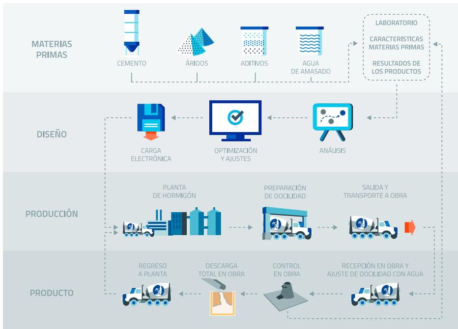
Todo el procedimiento descrito permite concluir que al controlar el asentamiento de cono se puede garantizar el resultado de las diversas características, incluyendo la calidad y resistencia del hormigón.
