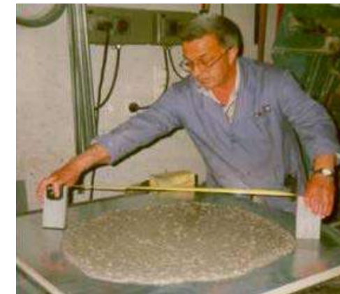
FIGURA 3.62 ESCURRIMIENTO DE HORMIGÓN AUTOCOMPACTANTE
